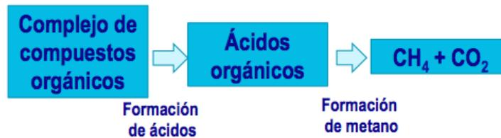
**Figura 6-9. Esquema del proceso de formación de metano en embalses.**
